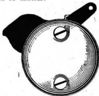
Fig. 7 bis. — Cloche (emboutie) avec volet de départ.
